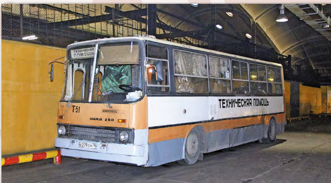
Одна из последних в городе машин технической помощи, сделанная из автобуса Икарус 280 путём переоборудования и отцепления прицепа («обрубок»)
