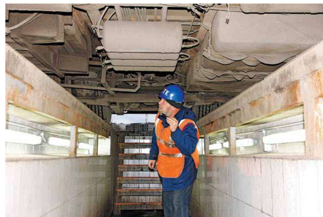
Осмотр автобуса механиком ОТК при въезде в парк
